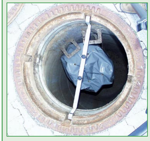
Рис. 2. Взрывозащищенный пробоотборник WaterSam Porti EX и пример установки в колодце
